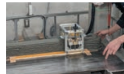
補強材導入実験中の3D印刷コンクリート
